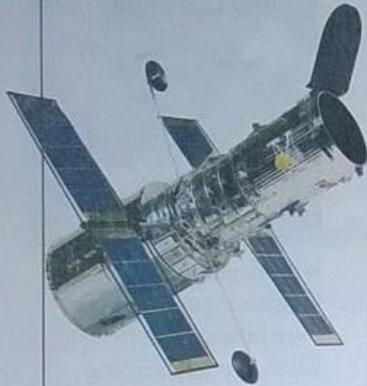
El Telescopio Espacial Hubble detecta ondas ultravioleta, luz visible y ondas infrarrojas. Sus cámaras han fotografiado los planetas de nuestro sistema solar, el nacimiento de nuevas estrellas y la tremenda explosión que se produce cuando la vida de una estrella se acerca a su fin.
